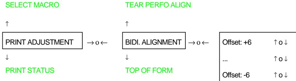
La alineación de la impresión bidireccional se regula utilizando una gama de valores entre - 6 y + 6. Cuando el valor precedente se cambia, la impresora imprime dos líneas de ‘|’ para controlar el resultado final.
