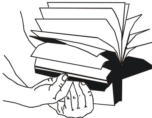
5. Cargar las hojas en el contenedor. Ajustar la guía derecha del papel según sea el ancho de las hojas asegurándose de que el papel no quede demasiado ajustado en el contenedor. Bloquear ambas guías del papel bajando las palancas.
