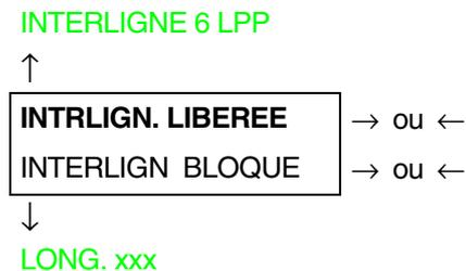
**INTRLIGN. LIBEREE** En sélectionnant cette valeur, l'interligne peut être modifié aussi bien par logiciel que par le panneau de commande.
