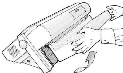
Figura 14. Apertura del trascinamoduli.
